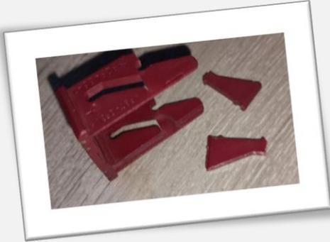
Les clips de connecteur qui permettent le branchement des phares avant des Opel Astra, sont fragile est-il arrive qu'il se casse à l'utilisation.
